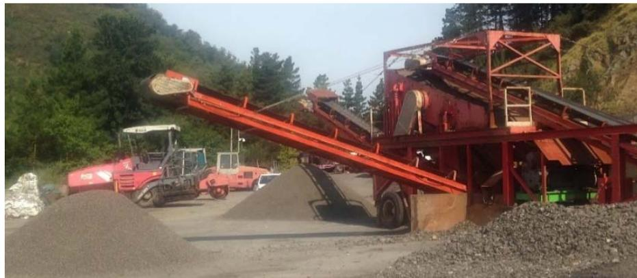
**Figura2.** Clasificación del material de fresado en varias fracciones.
