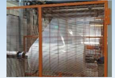
1.5 Refilo lamina, taglio opportuno degli estremi della lamina, recupero degli sfridi direttamente in estrusione e avvolgimento della bobina
