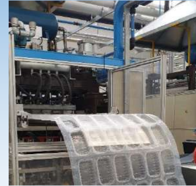
2.4 – TERMOFORMATURA. La lamina rammollita entra all'interno dello stampo (costituito da apposite cavità con la forma esatta del contenitore finale) che chiudendosi conferisce al materiale la forma voluta.
