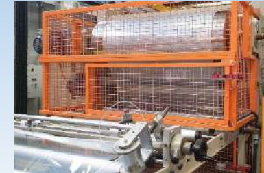
1.5 Refilo lamina, taglio opportuno degli estremi della lamina, recupero degli sfridi direttamente in estrusione e avvolgimento della bobina
