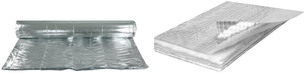
**Air-bur Termic 15:** Aislamiento termoacústico reflectivo multicapa de 15 capas de compuesto por: 2 láminas de poliéster metalizado armado, 2 guatas de poliéster, 6 láminas reflectoras y 5 espumas de polietileno de 1 mm.
