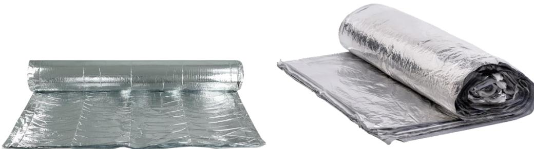
**Air-bur Multitermic:** Aislamiento termoacústico reflectivo multicapa de 7 capas de compuesto por: 2 láminas de aluminio puro, 2 burbujas de aire seco, 2 guatas de poliéster de 80 gr/m<sup>3</sup> y 1 lámina reflectora.
