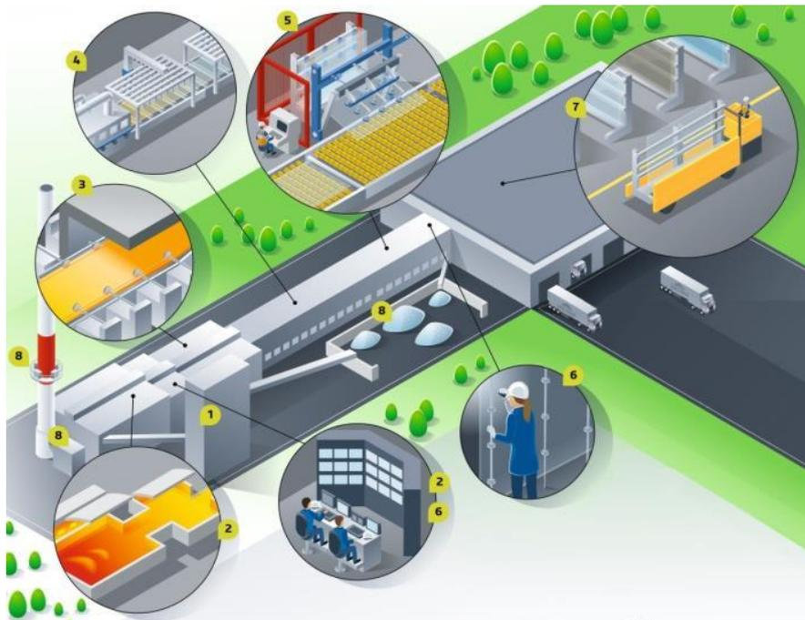
1. **MISTURADOR DO LOTE:** Mistura de matérias-primas (sílica, carbonato de sódio, cal, feldspato e dolomita) às quais se adiciona vidro reciclado (cacos de vidro) e outros compostos dependendo da cor e propriedades desejadas.
