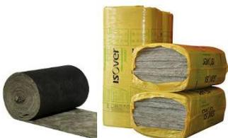
**Lana mineral Ecovent VN 032.** Panel semirrígido de Lana Mineral Arena, no hidrófilo, revestido en una de sus caras con un velo o tejido de vidrio negro de gran resistencia mecánica.
