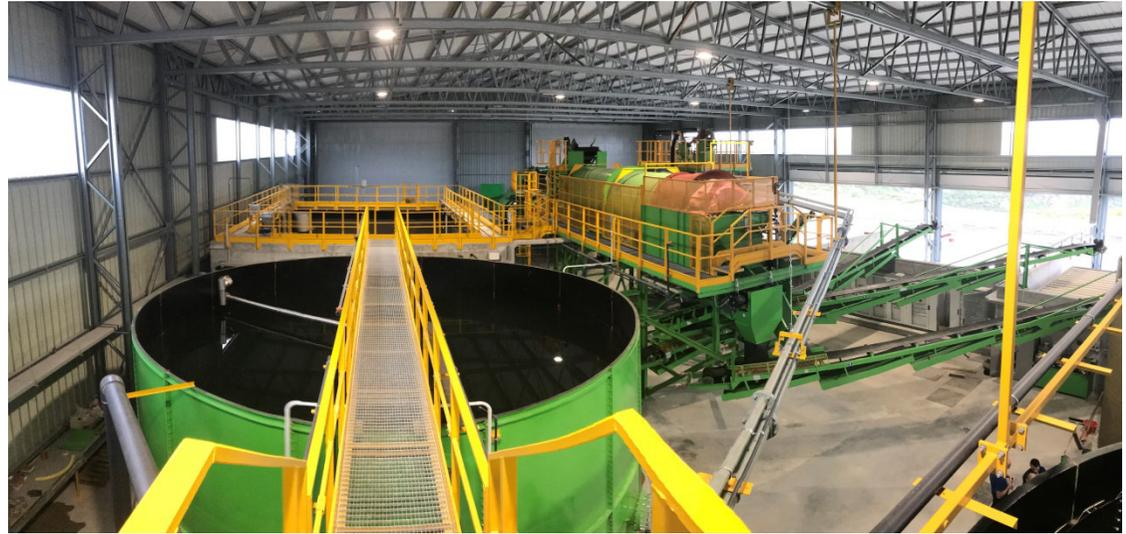
Nella **sezione di stoccaggio** i rifiuti vengono conferiti con autospazzatrici, auto spurghi e automezzi con cassoni; da qui vengono alimentati alle successive fasi di trattamento con l'ausilio di macchine operatrici.
