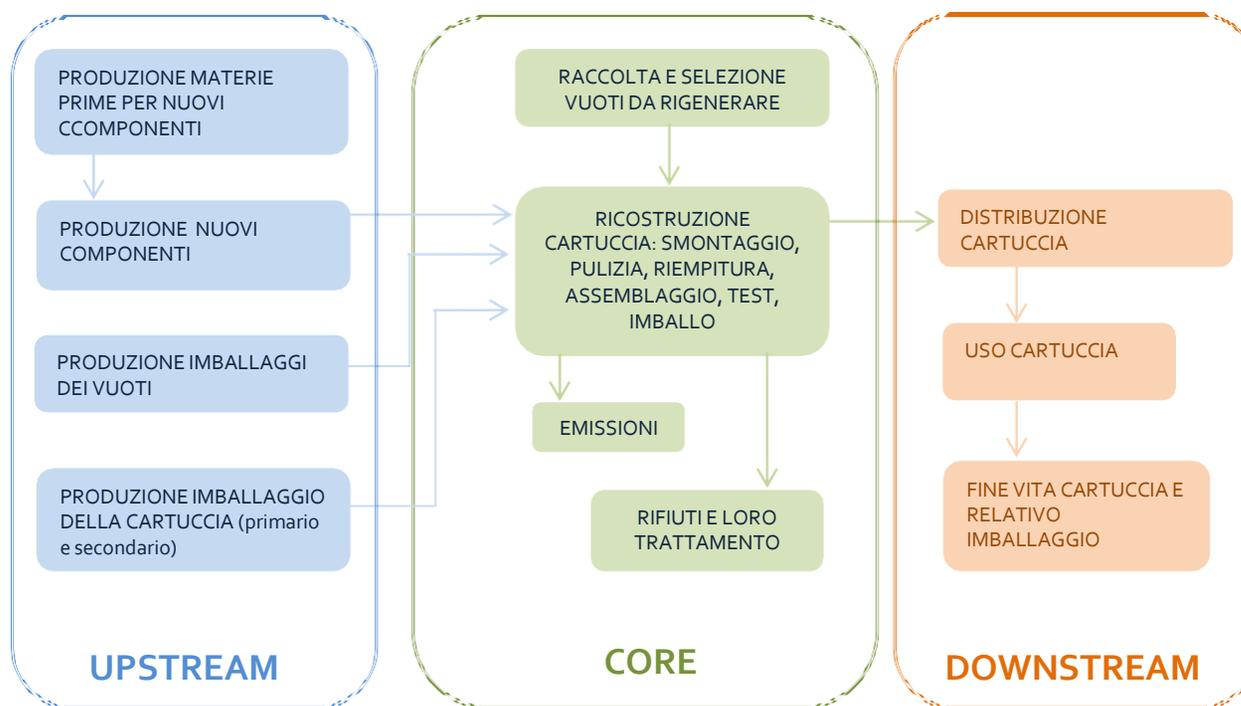
Fig. 1 – Confini del sistema della cartuccia rigenerata per stampanti laser.
