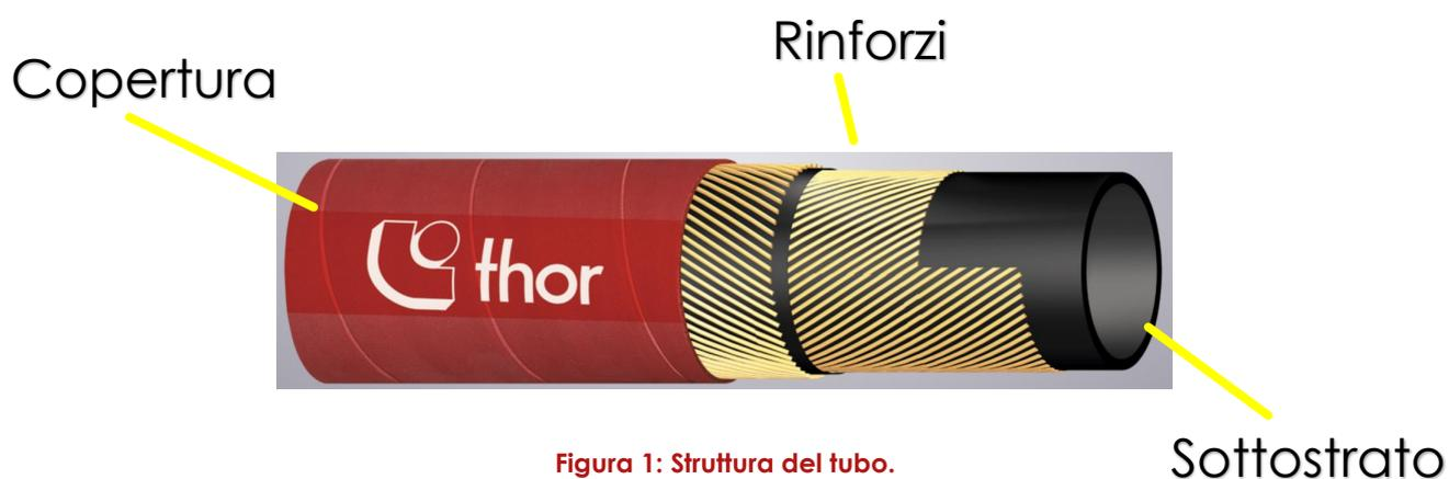
Figura 1: Struttura del tubo.
