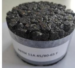
**Figura2.** Mezcla Asfáltica BBTM11A 45/80/65-F
